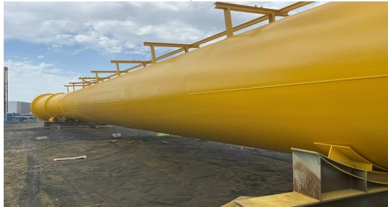
Nous pouvons dissocier le corps de la conduite de l'ensemble mécano-soudé posé sur le dessus et créer pour la même pièce un autre lot avec un nombre de mesures propre, mais avec les mêmes critères d'acceptation.
