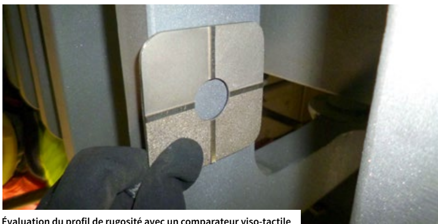
Évaluation du profil de rugosité avec un comparateur viso-tactile
