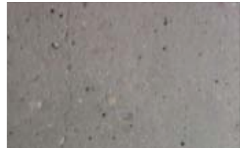
Visuel de différents bétons après projection d'abrasifs
